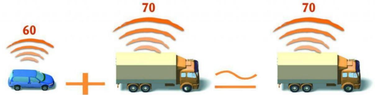
En effet, lorsque le bruit est doublé en intensité, le nombre de décibels est augmenté de 3. Par exemple, si le bruit occasionné par une source de bruit est de 60 dB(A), alors, pour deux sources du même type émettant simultanément, l'intensité devient 63 dB(A).
