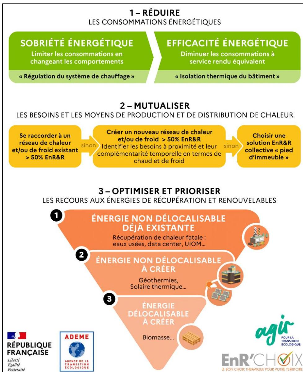
Figure 4 : Diagramme d'aide à la décision détaillant la priorisation à adopter sur les thématiques de chaleur renouvelable.
