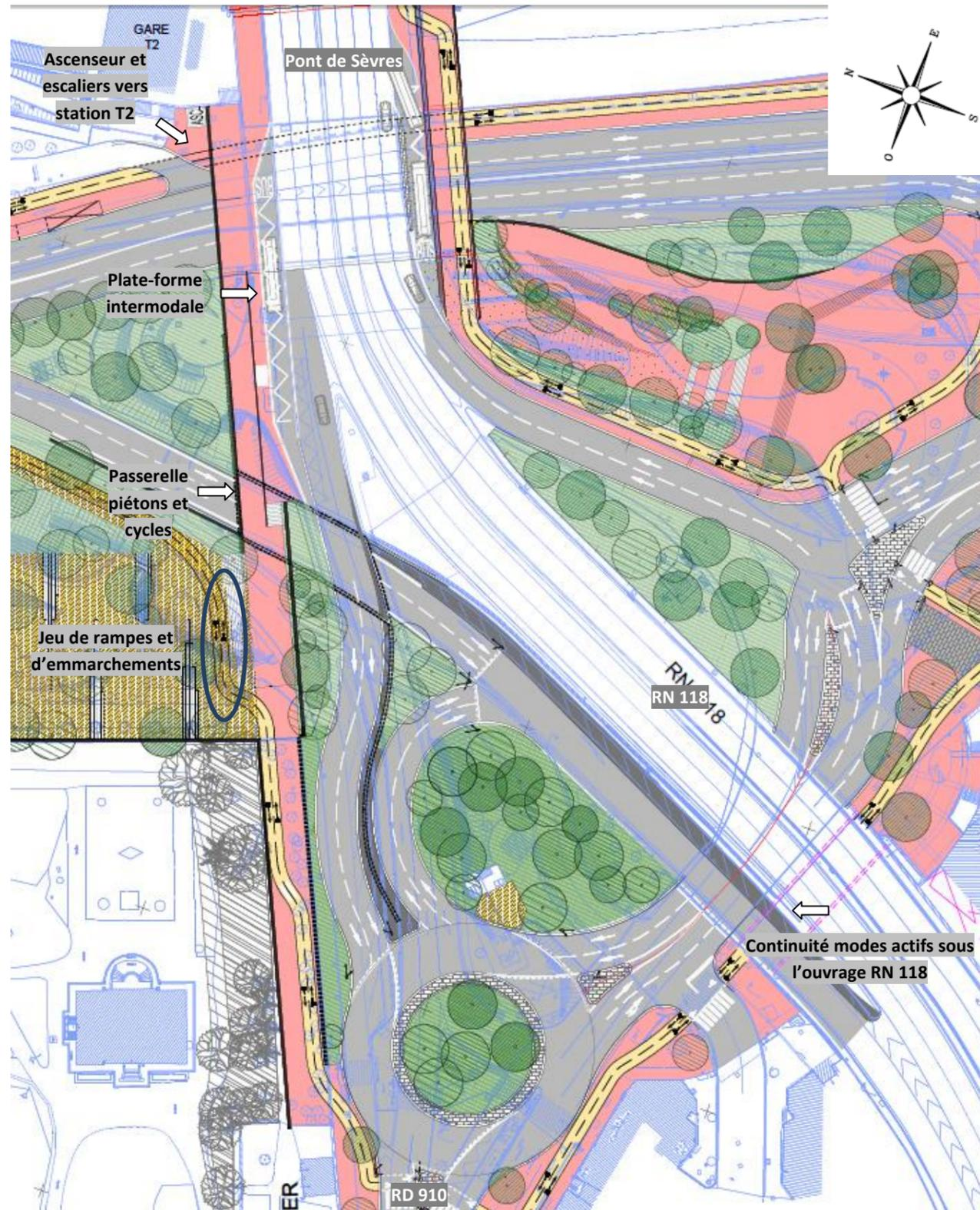
Figure 12 : Vue en plan des aménagements prévus sur le secteur entrée de ville de Sèvres et rive Nord du pont de Sèvres (source : Etude préliminaire, Iris Aménagement décembre 2013)
