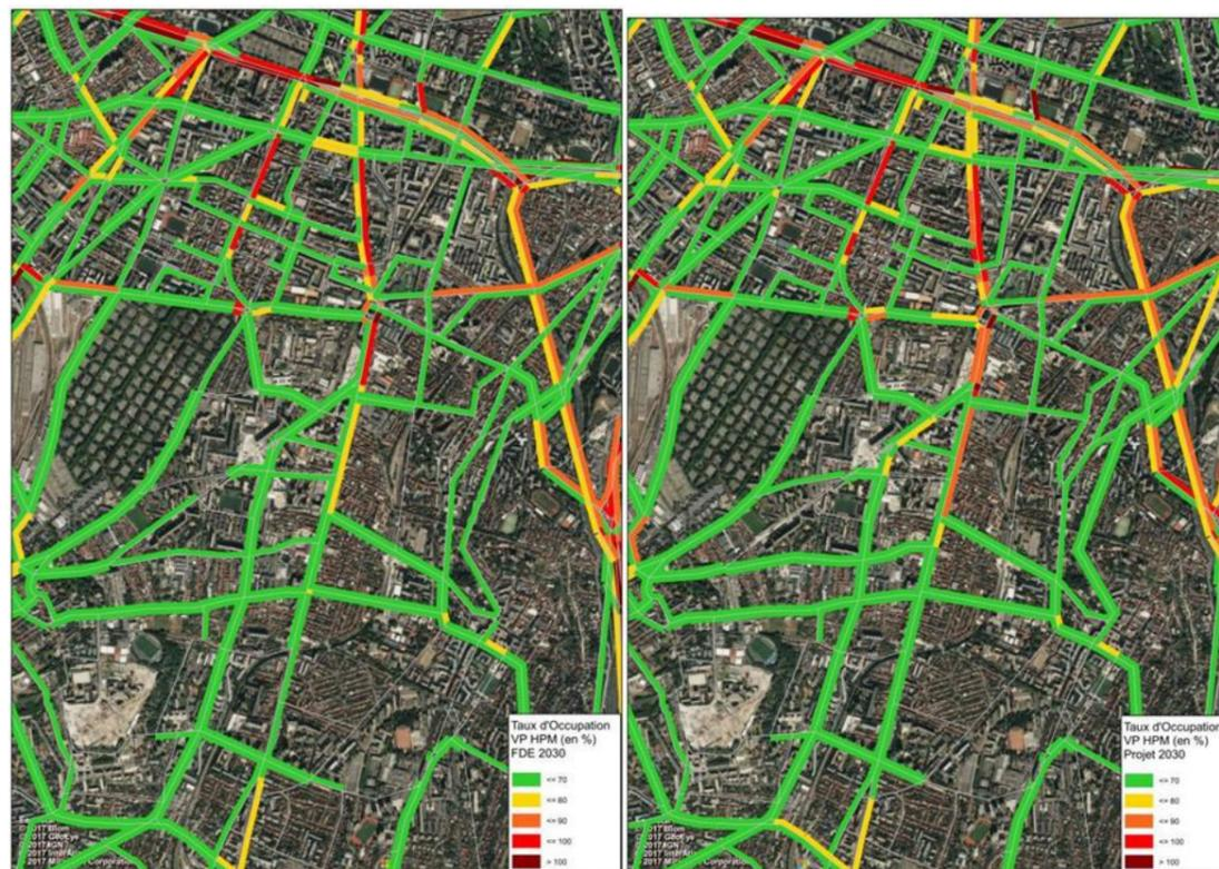
FIGURE 20 : NIVEAUX DE SATURATION A L'HPM 2030 SCENARIO FDL (ILLUSTRATION DE GAUCHE) ET EN SCENARIO DE PROJET 2030 (ILLUSTRATION DE DROITE)
