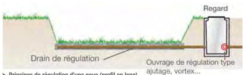
► Principes de régulation d'une noue (profil en long) (source: SEPIA Conseils) 4
