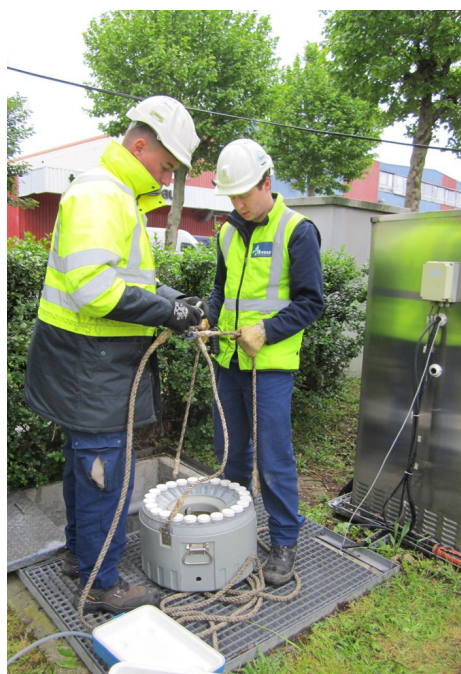
Figure 6 : Mise en place de préleveurs automatique pour analyse des effluents
